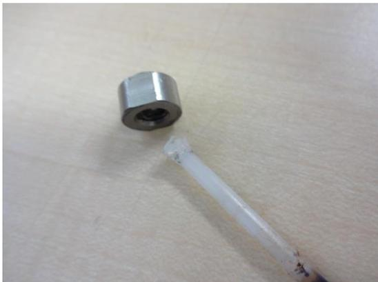
12の手順を終えると、キャップとチューブのつまりを確認します。図のようにチューブが破損または焦げが発生した場合、エクストルーダーの交換または一部交換が必要になります。
