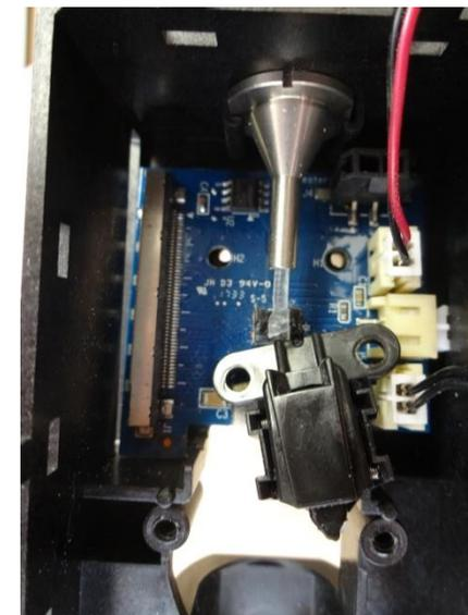
ノズル部を取り外したらセンサー部を取り外すことができます。
