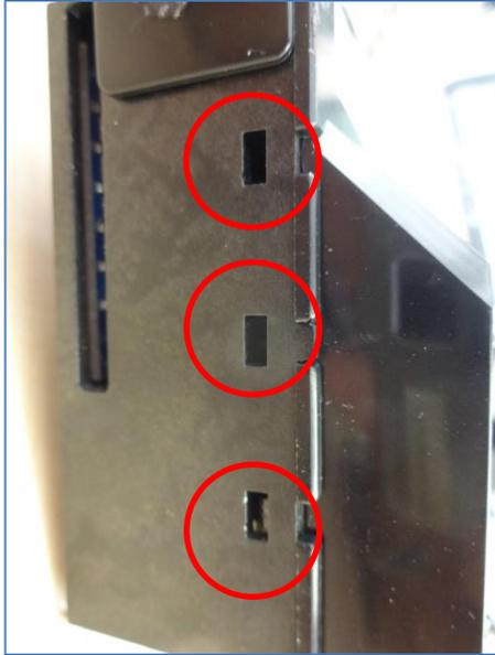
「ノズルの取り外しかた」に参考し、エクストルーダーを取り外します。エクストルーダーカバーは左右赤丸にある爪で固定しています。
