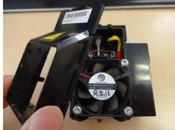
爪を解除した後に、カバーを取り外します。
